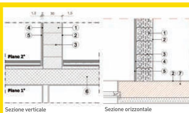
Parete provata: ambiente emettente – ambiente ricevente.
