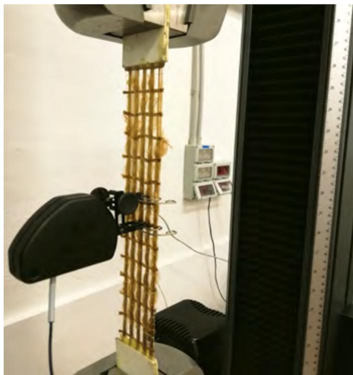
Prova di trazione uniassiale della rete secca in PBO.
