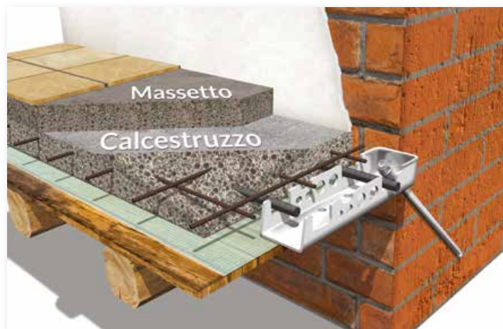
Sistema di consolidamento statico e antisismico dei solai con Connettore CentroStorico Acciaio Avvitato e Calcestruzzo CentroStorico, calcestruzzo leggero strutturale fibrorinforzato a ritiro compensato e asciugatura controllata adatto anche alla posa diretta della pavimentazione.
