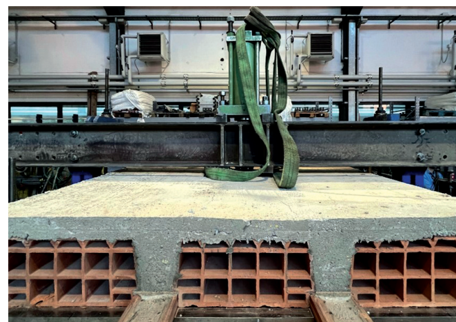
Dettaglio della sezione di solaio.
