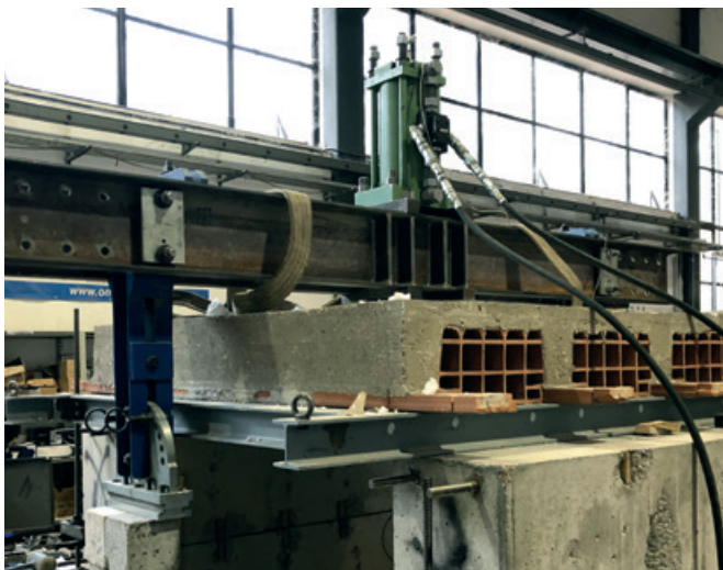
Prove di carico del sistema SAFENET.
